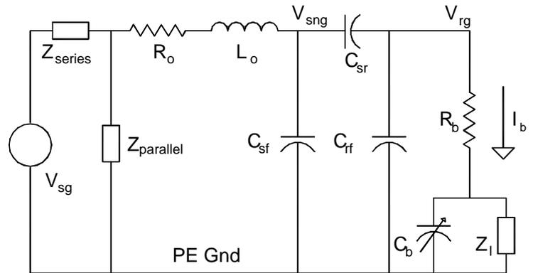
Fig. 5 Common mode equivalent model<sup>5</sup>
