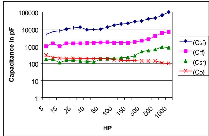
Fig. 6 Relative Motor Capacitance Values<sup>5</sup>
