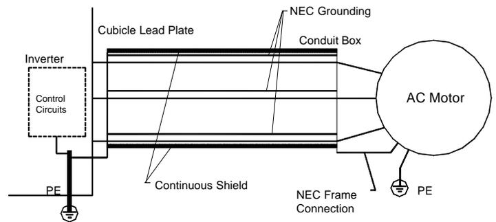
Fig. 9a Cable Configuration Diagram<sup>12</sup>
